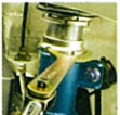
トルクレンチとジョイントで車高調整専用引口を2箇所調整してください。
